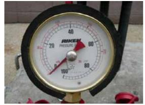
圧力計の置針を"0"に合わせます。 (圧力計中央のツマミを回すと赤針が回ります)
