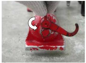
ロックピンをはずし、空気弁を 開放します。
